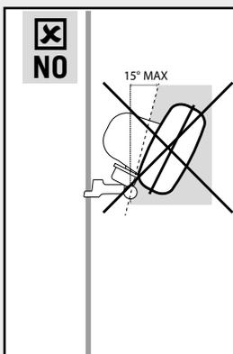
L'utilisation de la fonction oscillante lorsque le ventilateur penche vers l'avant de plus de 15 degrés endommage le moteur et raccourcit la durée de vie de votre produit.
